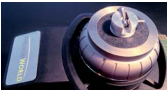
Abb. 22 REM-Probenhalter mit Implantat vor den Einschleusen
