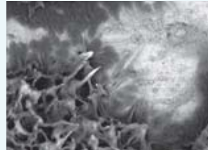
Knochenwachstum auf Implantat mit biomimetischem Monolayer (2500x)
