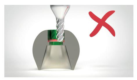
Der Sitz für den Schraubenkopf innerhalb der Suprakonstruktion kann NICHT mit den üblicherweise verwendeten Kugelfräsern gefertigt werden.
